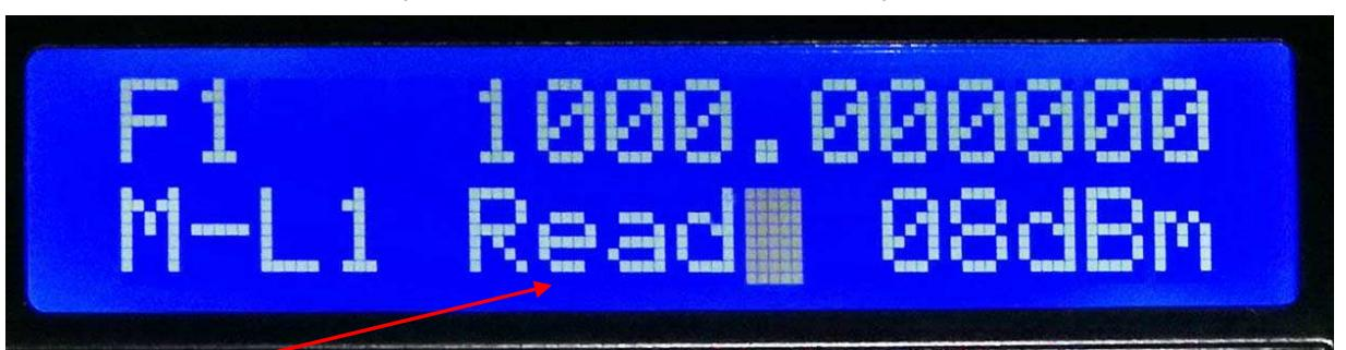
"Read"が表示され、F1の出力端子に5.6782Hzの8 dBmが出力される。
